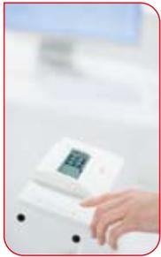
Le technologie sans fil seca 360° wireless permet au seca 703 d'envoyer chaque valeur mesurée vers une imprimante sans fil seca disponible en option ou vers le logiciel seca installé sur votre ordinateur, et ce par simple activation d'une touche.
