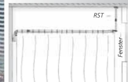
A cause d'une fenêtre, impossibilité de monter l'élément opposé, prendre statif au plafond.
